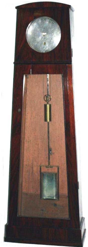
Abb. xxx: Die ungewöhnlich trapezförmige, vorne verglaste PPU (Höhe 143, Breite 48 unt./32 ob., Tiefe 22 cm) von Joh. Friedrich Wicke Bremen, etwa 1830.
