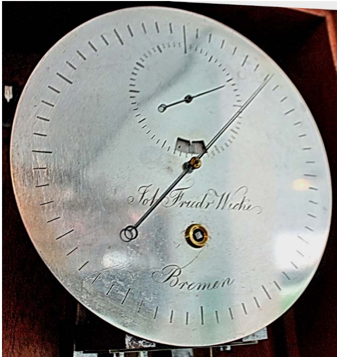
Abb. xxx: Versilbertes Regulatorzifferblatt (Ø 215 mm), signiert „Joh. Friedr. Wicke Bremen“, mit einem unter der Sekundenanzeige drehenden und durch einen Zifferblattausschnitt zu sehenden Stundenanzeige.
