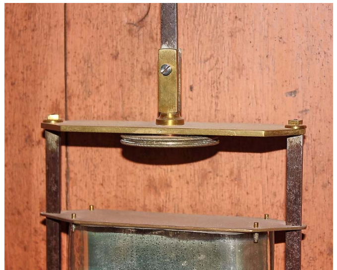
Abb. xxx: Die große skalierte Stellschraube an der flachen Pendelstange oberhalb des Quecksilbergefäßes für die Einstellung des Gangs der Wicke-PPU.
