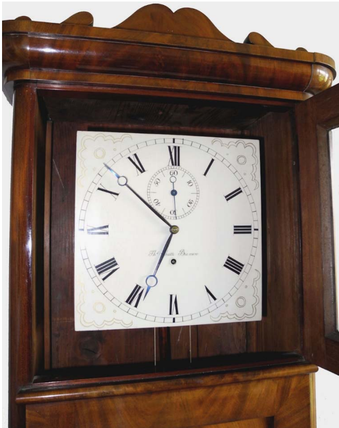
Abb. xxxx: Geöffnete Kopftüre des Gehäuses mit Blick auf das auf einem stabilen gusseisernen „A“-förmigen Werkträger (ca. H. 20,7 x B. 8,2 (unt.) x T. 11,5 cm) befestigte Werk und Zifferblatt (217 mm im Quadrat) des Schüttes-Regulators etwa 1840. Oben ist der ca. 6 cm hohe geschwungene, nicht abnehmbare Gehäuseaufsatz zu sehen.
