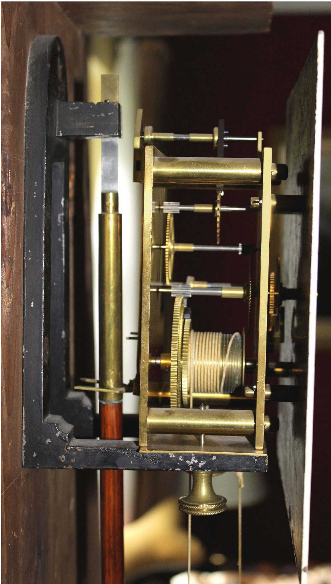
Abb. xxxx: Blick auf die andere Werkseite des Th d Schütte-Regulators etwa 1840. Hier ist der Tragestuhl komplett zu sehen, an dem das ca. 5 kg schwere Pendel aufgehängt ist. Ebenso wie die breite Pendelfeder, die Pendelgabel mit der Mikrometer-Abfalleinstellung und der runde rötlich-braune Holzstab in Köhler'scher Manier mit den angeetzten Messingzylindern oben und unten.
