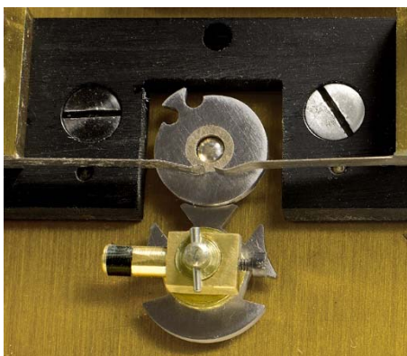
Abb. xxxx – zzzz: Die Rekonstruktion des verlorenen Alarm-Contactes an der Welle des feststehenden Federhauses. (ob. li.) Eine scheinbar einfache Aufgabe den Schaltkontakt wieder herzustellen und an der Welle anzubringen. Aber es waren drei aufwändige Versuche (ob. re.) notwendig, um das Malteserkreuz in einer endgültigen Form funktionsfähig zu haben (ob. re.). Der Restaurator Ian D. Fowler schreibt dazu: Ich wollte partout die Malteserkreuzstellung vermeiden, weil sie sehr schwierig in der Herstellung ist. [...] Wir verwenden 3 von etwa 6 möglichen Umdrehungen des Federkerns, was 210 Stunden = 8,75 Tage sind. Kontaktschließung ein paar Stunden vorher.“ In den Bildern unten sieht man den Ablauf von links nach rechts bis der Kontakt geschlossen ist und ein elektrisches Signal schaltet. Auch an dieser Arbeit sieht man, dass das Werk ein Einzelstück ist, weil die dunklen isolierenden Holzteile nicht exakt ausgesägt sind. Fotos (ohne die Fotos der Einzelteile des Malteserkreuzes): Manfred Obersteiner, Brodenbach/Mosel
