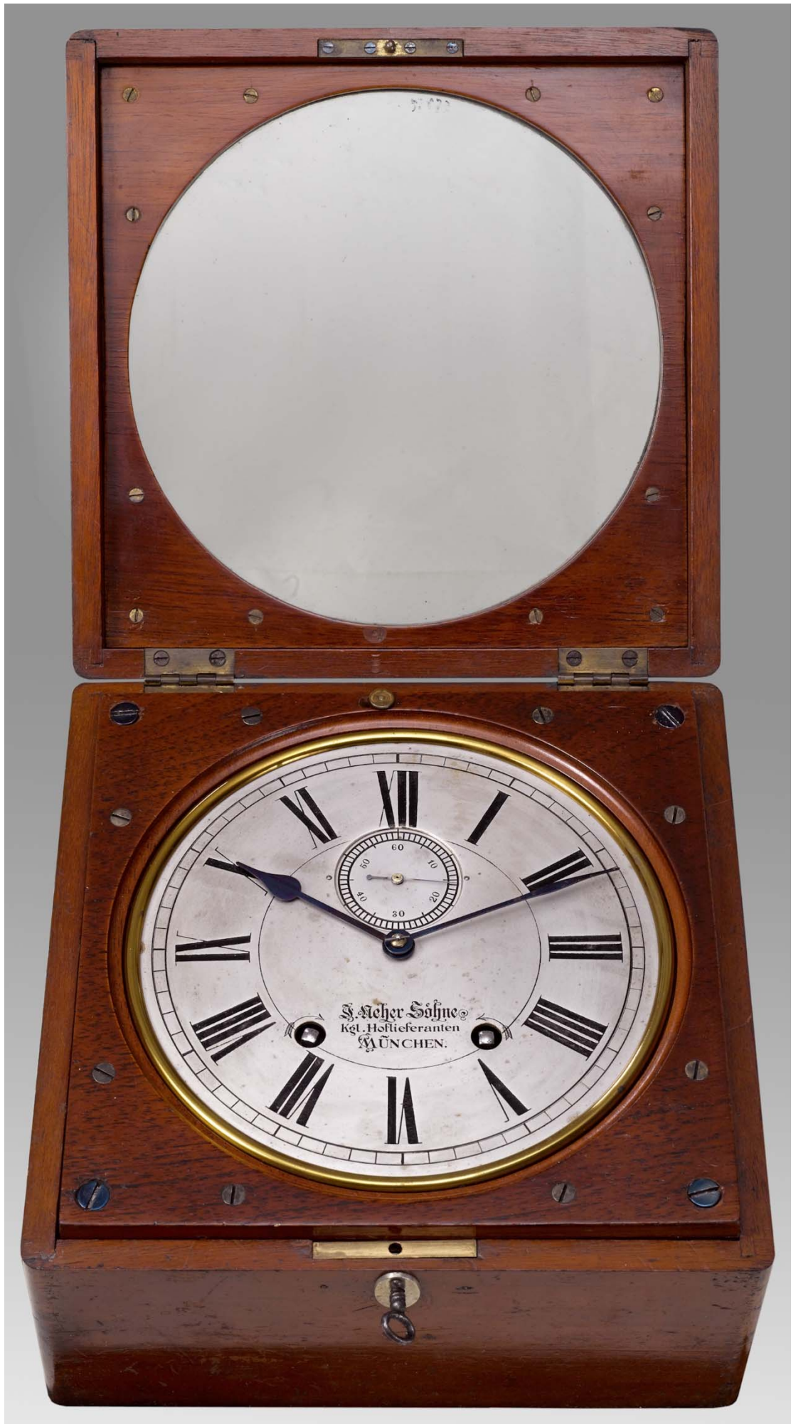
Abb. xxxx: Die aufgeklappte Mahagoni-Box des einzigartigen Neher Söhne-8-Tage-Chronometers auf Basis eines Lenzkirch-Regulatorwerkes. Gut zu sehen das runde versilberte und gravierte Zifferblatt mit der Signatur „J. Neher Söhne Kgl. Hoflieferanten München“ sowie die Sekundenanzeige oben bei der „XII“. Ebenso den zweiten Aufzug (rechts) für den Antrieb des Polwende-Werkes zum Anschluss von elektrisch geschalteten Nebenuhren. Foto: Manfred Obersteiner, Brodenbach/Mosel
