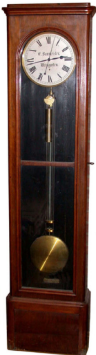
Abb. 611: Die frühe etwa 1,80 m hohe Mahagoni-Sekundenstanduhr etwa 1880 mit der Signatur „E. Baummeister Weingarten“ und Zentralsekunde. Gut erkennbar, dass die innenliegende Zink-/Stahl-Kompensationspendel.
