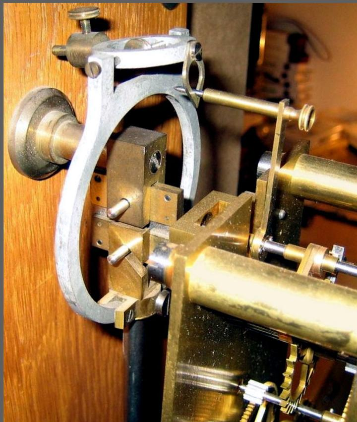
Die von Heinz Odenbach, Willich-Schiefbahn (NRW), im Alter von 19 Jahren im Jahr 1940 selbstgefertigte PPU mit spezifischer Pendelhemmung mit konstantem Antrieb (Pendel-Chronometerhemmung). Details s.u. im Artikel. Fotos: Martin Odenbach, Wegberg
