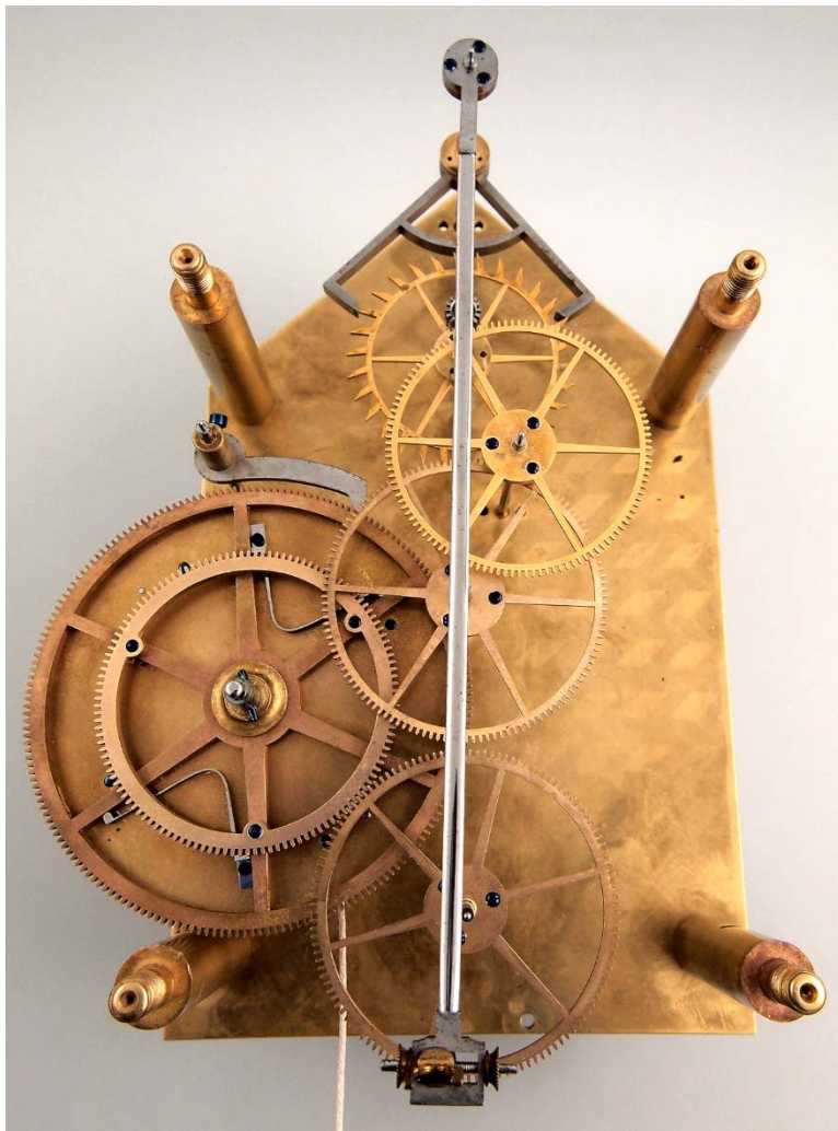
Abb. 6: Das Werk des eher unbekannten PPU-Fertigers ( Leopold? ) Dreyer, Hofuhrmacher in Schwerin (Mecklenburg) mit Graham-Hemmung und Saphir-Paletten. Eine PPU mit ungewöhnlichen Quecksilberkompensationspendel mit zwei Zylindern, um 1870 (s.u.). Foto: Andreas Hidding - Klassische & Antike Uhren, Raesfeld
